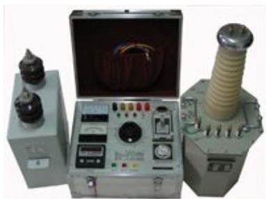
电缆故障测试高压冲击放电部分
